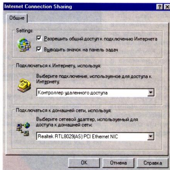
Средство общего доступа в Internet, встроенное в Windows 98/Me/XP, разделит Internet-канал между всеми компьютерами в ЛВС
