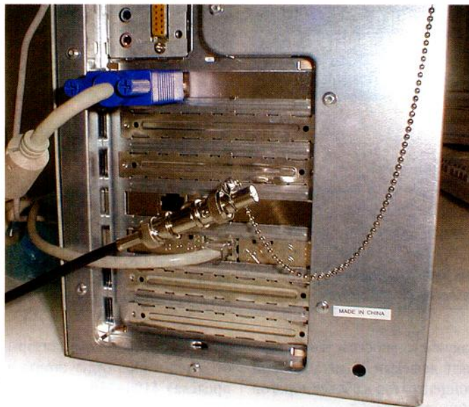
В сети на коаксиальном кабеле заземлять терминатор на корпус компьютера можно только в том случае, если вы твердо уверены, что сам корпус ПК имеет правильное заземление
